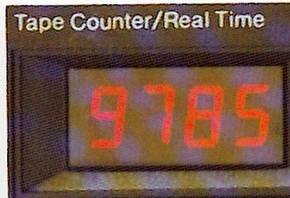
Ein Bandzählwerk, das zwischen normaler Zählfunktion und einer Echtzeitanzeige umschaltbar ist. Das Zählwerk kann auf jedes Band geeicht werden, um sowohl während des Umspulens als auch im normalen Betrieb eine ständig genaue Anzeige zu gewährleisten. Diese Umschaltung kann jederzeit erfolgen.
